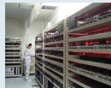
レーザー製品の初期スクリーニングは、10,000時間以上の寿命特性と長期にわたる信頼性の確保に欠かせません。京セラSOCのレーザー製品は、半導体レーザーの初期故障およびレーザーアライメントの確実性を確認するために、連続運転および断続運転によるスクリーニングを全ての製品で実施することにより初期不良を取り除き、偶発故障領域での不良率を0.1%以下に抑制して信頼性を高めています。
