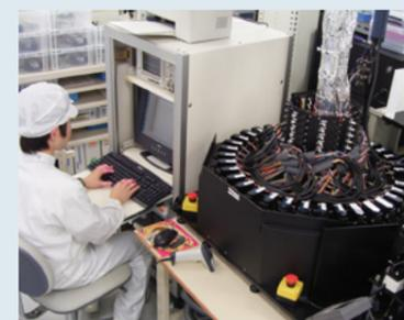
出荷実績50,000台を超える製品の最終検査では、レーザー出力、光ノイズ、偏光消光比、偏光方向、出力特性などが自動検査により測定、判定されます。最大35台のレーザーをセットアップした自動検査装置は、無人状態で検査が進行、完了して月産1,000台のキャパシティと大幅な効率化が図られています。また、自動検査装置の精度確認は始業点検として都度実施され品質保証を確かなものとしています。
