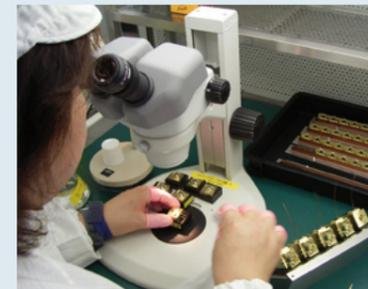
レーザー製品に用いる部品は清浄であることが求められます。混入した異物または有機性ガスの付着によるレーザーの共振器ロス増大は、長期にわたるレーザーの信頼性を大きく損ないます。京セラSOCの製造工程では金属部品の加工時に付着する油脂、金属くすなどを界面活性剤による洗浄と超音波洗浄により除去し、さらに真空中での高温加熱によりアウトガスを除去して部品の清浄度を維持しています。また、組立作業はクリーン度10,000以下のクリーンルーム内で完結し塵埃に対する管理が成されています。清浄な部品と清浄な作業環境で製造されたレーザーは、10,000時間以上の寿命が得られています。
